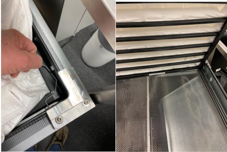
Um den Zugriff auf den sonst freiliegenden Walzenpropeller zu verhindern wurde ein starkes Metallgitter eingeschraubt, das in der Mitte mit einem Metallbügel gegen Eindrücken gesichert wurde. Ebenso wurde dies für den Haupteinlass durchgeführt. In diesem Fall ist ein Bügel nicht notwendig.
