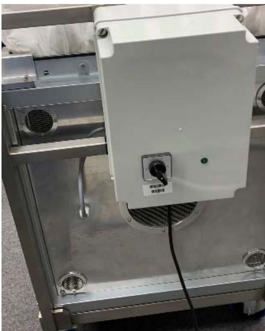
Motorseitig wurde der Motor mit einer Verteilerbox angeschlossen und die Kabel an die Steuereinheit geführt. Eine Metallplatte wurde gefertigt durch die die Kühl-Luft vom Motor eingesaugt werden kann und in den Ecken ausgeblasen wird. Alles wurde mit dem PU-Noppenschaum bezogen als Schallschutz.
