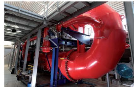
Der sechs Meter hohe und 18 Meter lange Turbulenz-Windkanal ist das Herzstück der Abteilung.
