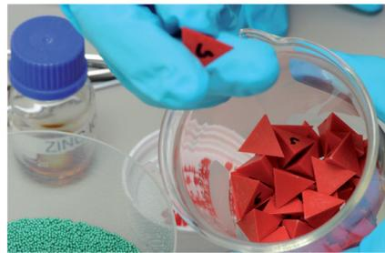
Im Experiment lässt sich das Zusammenspiel granularer Materie - etwa kleiner Kugeln oder regelmäßig geformter Tetraeder - genau untersuchen.
